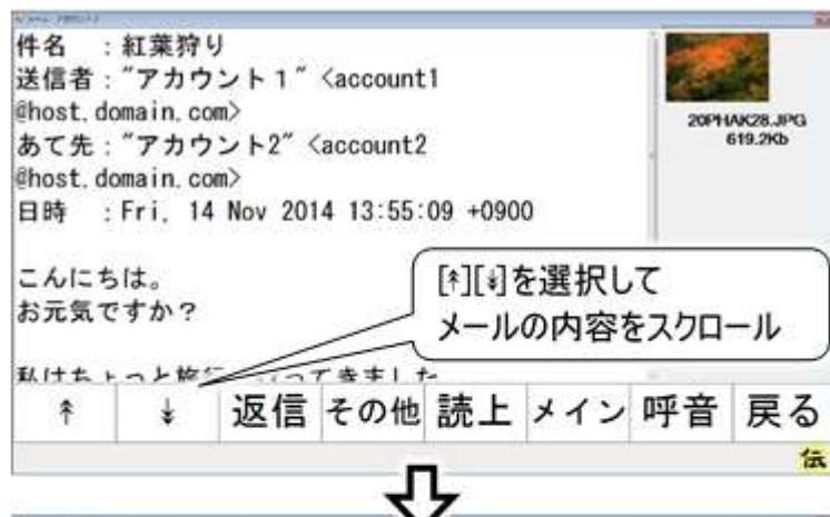
メールの内容は下から上方向、または上から下方向にスクロールしていきますので、スクロールを止めたいところでもう一度スイッチを入力すると、スクロールはそこで停止します。
