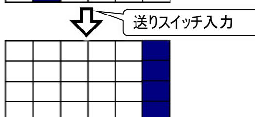
カーソルが右端に達すると、次の入力で左端に移動する
